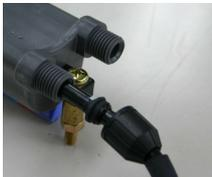
キャップを抜いて プラグコードを抜き取りますが、このときのキャップおよび防水ゴム部分は純正品を再利用しますのでご注意ください。
